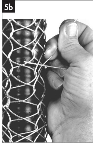
**6 WICHTIG: Entfernen Sie zunächst das Klebeband am oberen Ende des Ziehstrümpfes.** Fassen Sie mit beiden Händen um das untere Ende des Ziehstrümpfes, und schieben Sie sie gemäß Abbildung 6 nach oben. Durch diesen Zugvorgang werden Schlaffstellen aus dem Ziehstrümpf entfernt. Wiederholen Sie diesen Vorgang zweimal.
