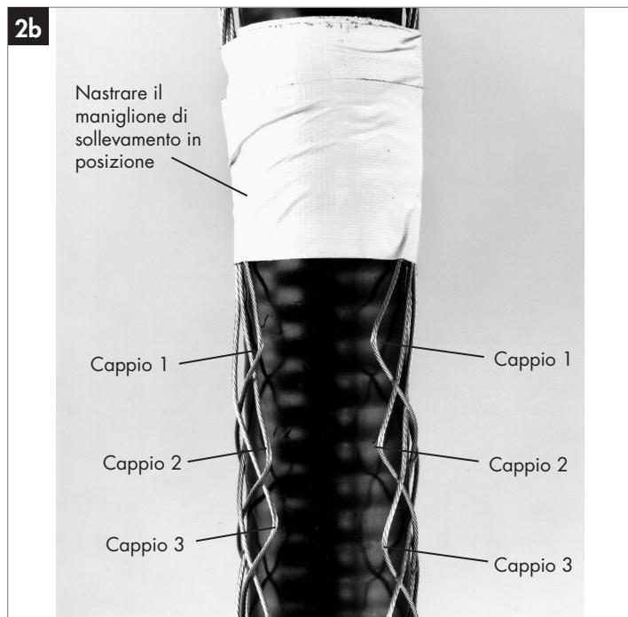
**3** Piegare il laccio a metà in modo da formare una piega nel centro. Iniziando dalla parte superiore, infilare il laccio nella prima coppia di cappi in modo tale che la piega si trovi in mezzo come illustrato nella Figura 3A. Incrociare le estremità del laccio e infilarle nella seconda coppia di cappi da sotto e tirare ad angolo retto come si fa quando si allacciano le scarpe (vedere Figura 3B).
