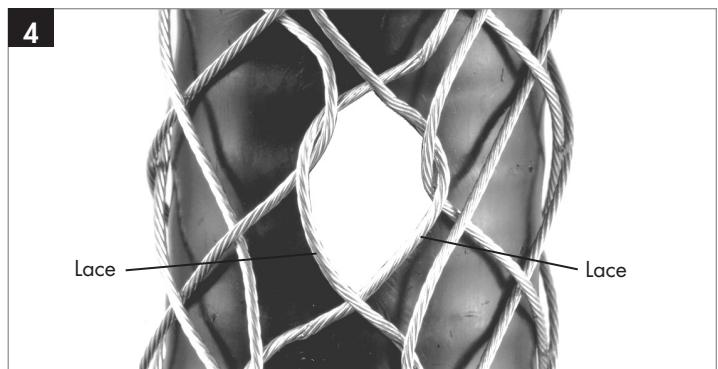
**5** Verdrillen Sie das Schnürband am Nahtende mehrere Male gemäß Abbildung 5A. Wickeln Sie das Schnürband um das Ziehstrümpf, verdrillen Sie es, und fädeln Sie den Rest des Schnürbands gemäß Abbildung 5B in das Ziehstrümpf. **Verknoten Sie das Schnürband nicht, da diese Knoten nicht halten!**
