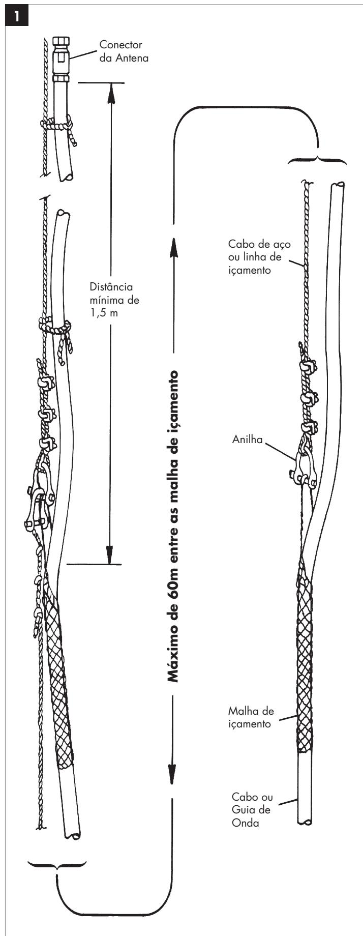
**2** Identifique os primeiros três pares de laços a serem atados nos terminais climpados conforme mostrado na Figura 2A. Verifique que os laços não estejam emaranhados. É importante que os pares de laços estejam emparelhados corretamente para assegurar o máximo de força de agarramento. Depois disso, prenda ambos os terminais climpados no cabo ou na guia de onda com fita conforme mostrado na Figura 2B. Isto alinhará os pares de laços da malha de içamento e facilitará o atamento.
