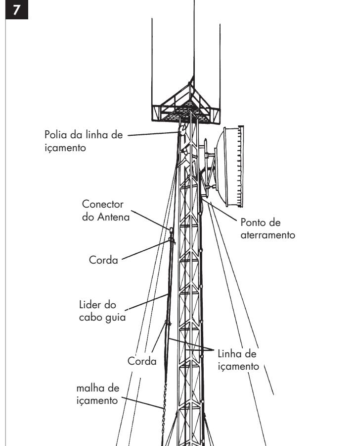
**6** **IMPORTANTE:** Primeiro, retire a fita da ponta da malha de içamento. Em seguida, coloque ambas as mãos firmemente em volta da parte inferior da malha e deslize-as para cima até o topo conforme mostrado na Figura 6. Esta ação de puxar eliminará o afrouxamento em toda a malha. Repita isso duas vezes.
