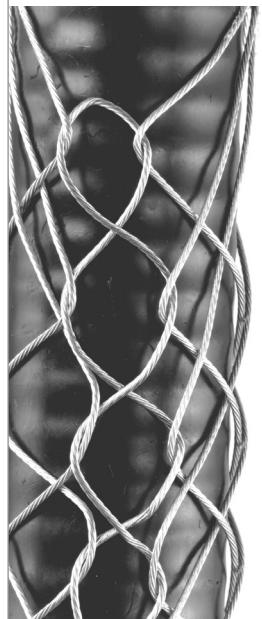
**4** Führen Sie den Schnürvorgang fort, so dass eine gerade Naht gebildet wird. Ziehen Sie das Schnürband so an, dass eine Nahtbreite entsteht, die nicht größer als die Breite der jeweiligen Maschen neben den Schlaufen ist. Siehe Abbildung 4. **Lassen Sie kein Schlaufenpaar beim Verschnüren aus.** Andernfalls wird das Haltevermögen des Netzes geschwächt. Das Ziehstrümpf kann von unten nach oben zusammengezogen werden, um das Verschnüren zu vereinfachen.
