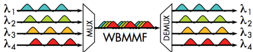
Figura 22. Multiplexação por divisão de onda curta sobre MMF de banda larga
