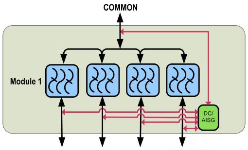
694-862MHz 880-960MHz 1710-1880MHz 1920-2170MHz 2300-2690MHz
